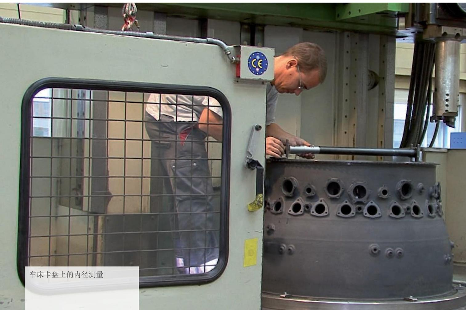
车床卡盘上的内径测量
