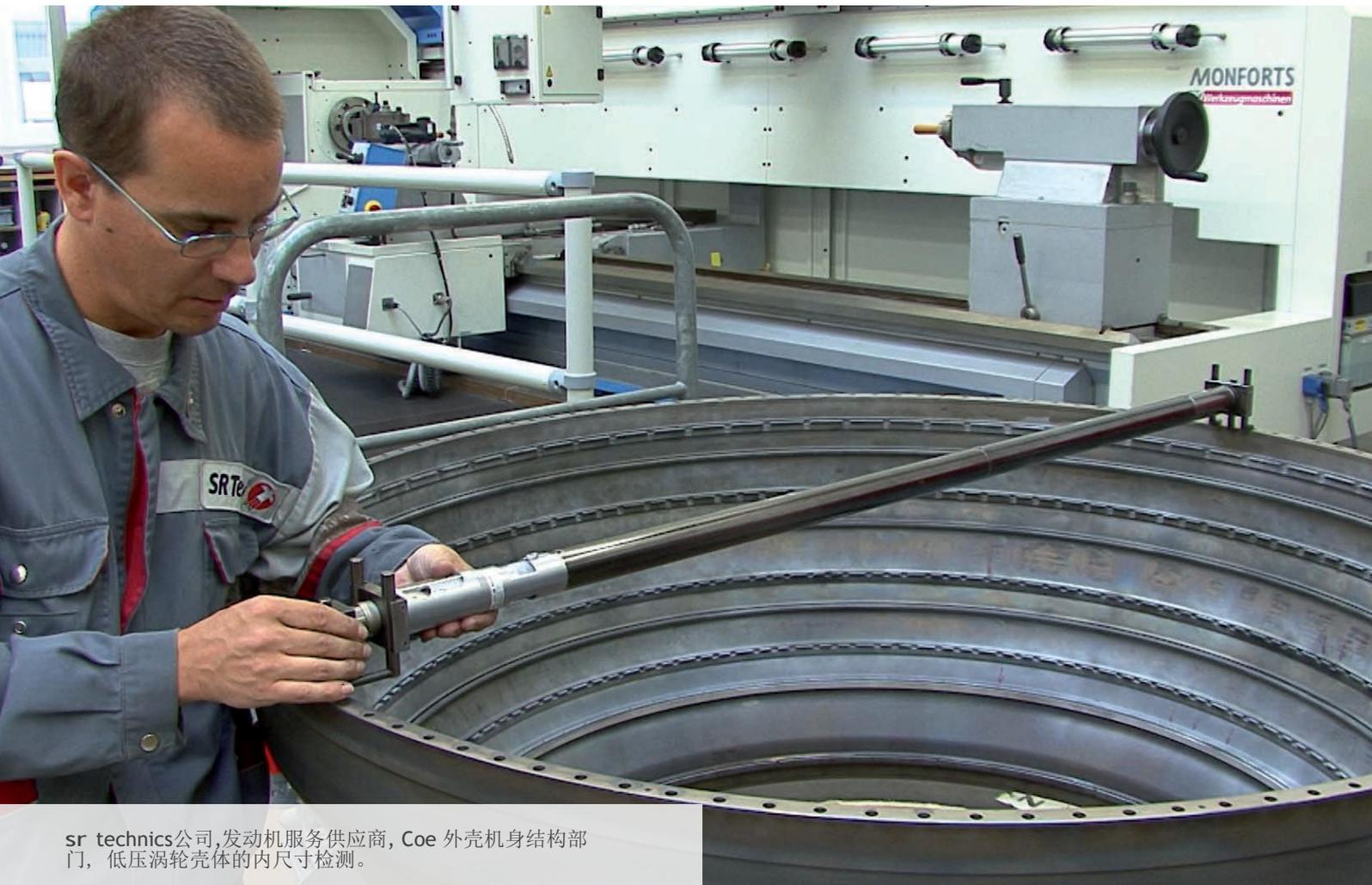
sr technics公司,发动机服务供应商, Coe 外壳机身结构部门, 低压涡轮壳体的内尺寸检测。
