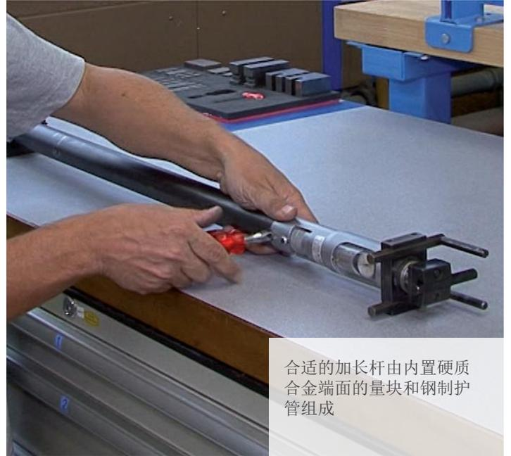
合适的加长杆由内置硬质合金端面的量块和钢制护管组成
